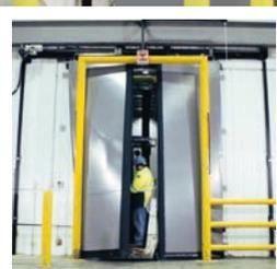
Flexible, schlagfeste Iso-Paneele ( $K=0.568 \text{ W/m}^2\text{K}$ )
